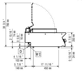
Drain Electrical inlet (power) ΕI Equipotential screw
